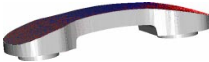
Figure VI.15 : Mise en correspondance de l'image 3D avec le modèle CAO STL.
