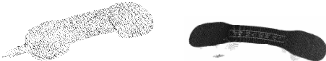
Figure C.V.3 : Ensemble de points 3D de la pièce réelle fournis par un capteur télémétrique (115753 points) (à gauche), image 3D seule (5289 points).
