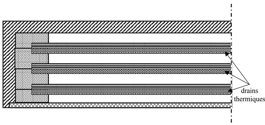
**Figure 4.7:** Intégration des drains thermiques dans la géométrie du demi-composant compact
