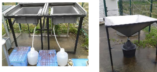
Figure 6-6. Mise en place des bidons de collecte
