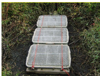
Figure 6-5. Piège à sédiments
