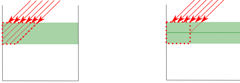
(a) Feuillage traversé par les rayons (b) Hypothèse utilisée dans l'équation 3.16
