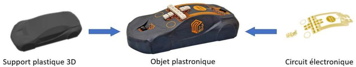
**Figure 0.1** Exemple de dispositif plastronique, assemblage d'un substrat plastique 3D avec un circuit électronique en surface [3].
