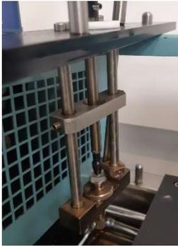
On utilise la cale de réglage pour positionner le capteur de déplacement à 2 mm de hauteur (petites vis de serrage à l'avant et à l'arrière du support supérieur). Suite à cette calibration, l'affichage doit indiquer une valeur proche de 2 mm à +/- 0,06.
