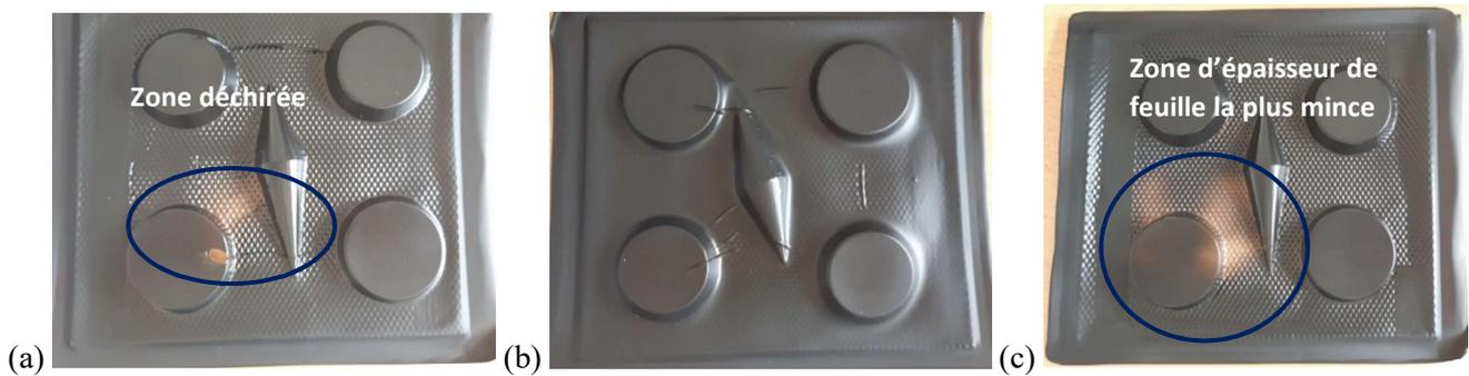
Figure 0.15 Optimisation du thermoformage de films PLA4 sans encre.
