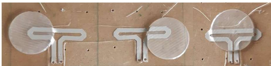
Figure III.25 Thermoformage des antennes sur substrat PLA1.
