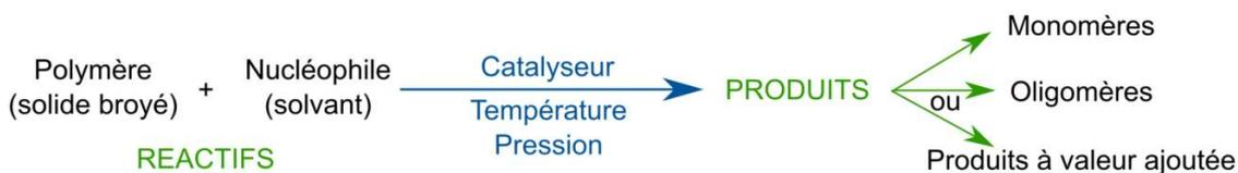
Figure IV.13 Schéma de base de la solvolyse.
