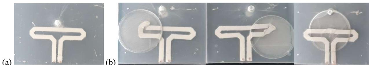
Figure III.26 Antennes sérigraphiées sur PLA1 et surmoulées avec PLA2 : (a) sans thermoformage, (b) avec thermoformage.
