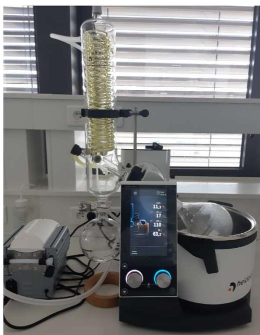
**Figure V.4** Evaporateur rotatif utilisé pour la séparation polymère/solvant au laboratoire.
