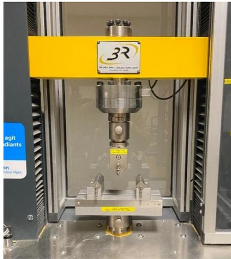
Figure 2-11 : Photographie de la machine polyvalente 3R montée en flexion 3 points.
