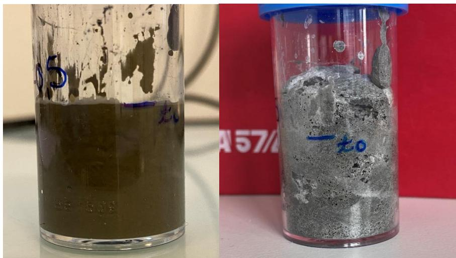
Figure 2-8 : Échantillon frais et échantillon après 7 jours de cure
