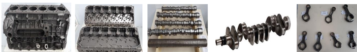
Figure 3. Composants principaux usinés chez FPT industrial
